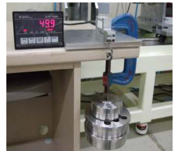
그림 2-(b) 손가락 집는 근력 측정 장비의 교정
