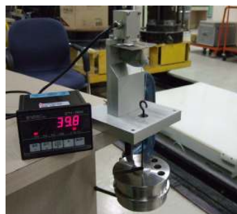
그림 2-(a) 손가락 구부림 근력 측정 장비의 교정
