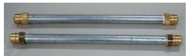
(b) 실제 난류발생 장치가 설치된 파이프
