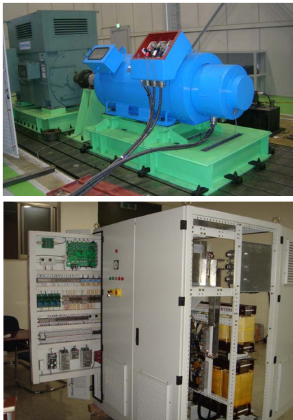
그림 10 실험에 사용한 DFIG 시스템 Fig. 10 Experimental Setup for DFIG Control.
