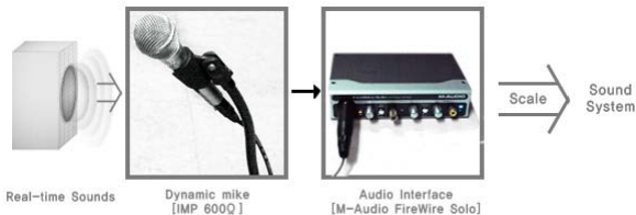
▶▶ 그림 7. 다이내믹 마이크를 통한 수음 구조도
