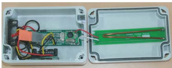
▶▶ 그림 9. Master Device
