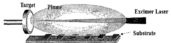
그림 1. 다양한 타겟과 기판의 거리를 조절 가능한 HW-PLD 시스템의 계략도
