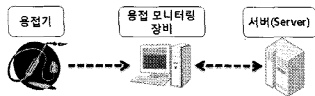
〈그림 1〉 무선 용접 모니터링 시스템 구성도
