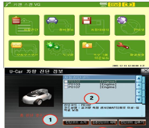
그림 2. GUI 차량 진단 툴 (CarMan ScanVG와 U-Car)
