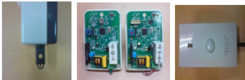
그림 3. 기류센서, 온도, 습도센서 및 동작 감지 센서
