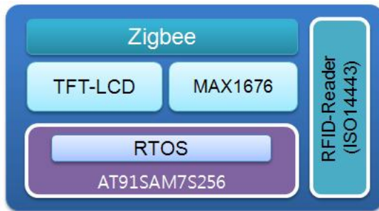
그림 3. 승무원용 단말기 내부 구조
