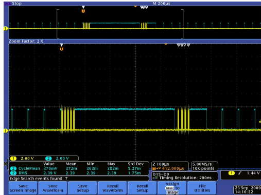
그림 10. ADS1256의 DRDY와 SCLK의 파형
