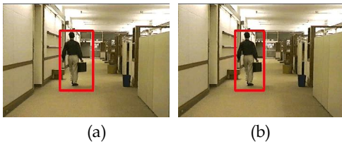
그림 4. 물체 추적 결과 영상(frame #53) : (a) 그림자 제거 전 (b) 그림자 제거 후
