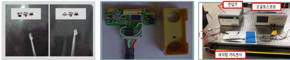
그림7. 가공된 렌즈 모습 그림8. 회로 기판과 경통 그림9. 성능 평가 세팅 모습
