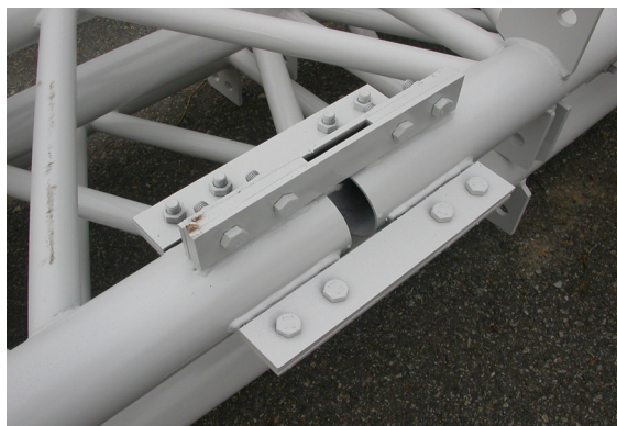
그림 2. Mock-up 구조물의 손상부재 제작
