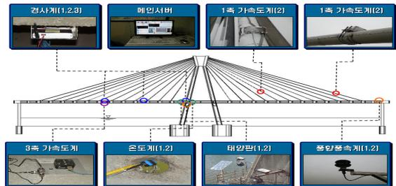
그림 2 센서의 설치 현황
