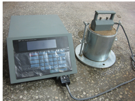
(b) QTM-500을 이용한 측정 모습
