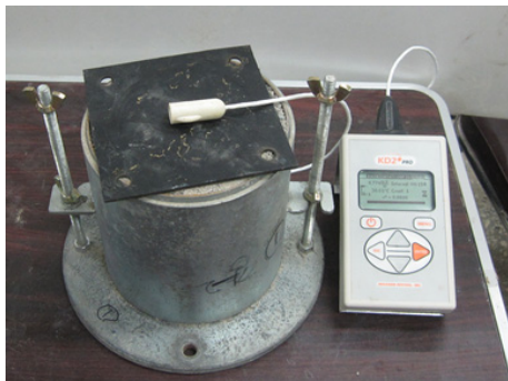
(a) KD2 Pro를 이용한 측정 모습
