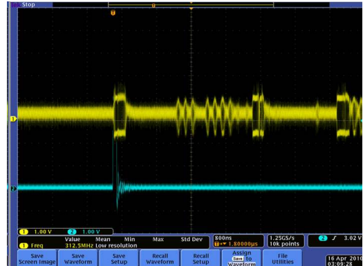
그림 2. RF 단에서 출력되는 Analog 신호
