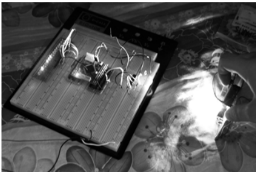
그림 4. 가시광 무선통신 모의실험
