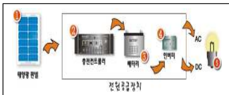
그림 1. 태양광 발전을 이용한 전원공급시스템의 계통도
