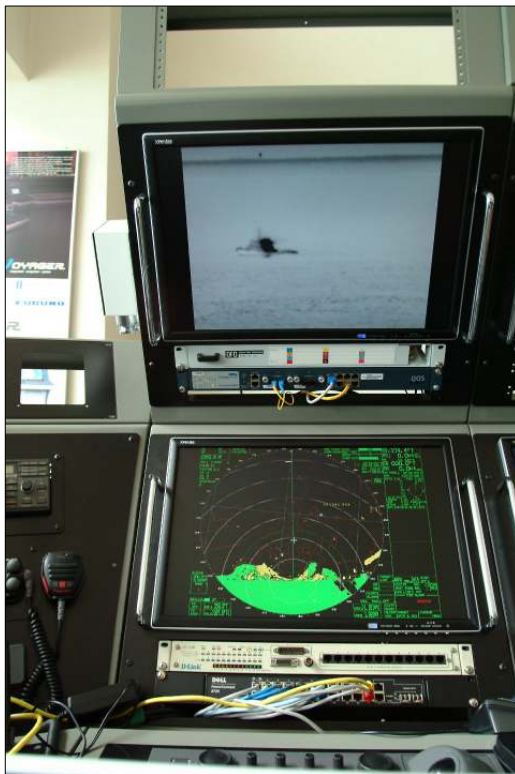
그림.1. CONSOLE 장비 RADAR (X-BAND), 선박 ARPA TARGET NMEA SIGNAL OUTPUT
