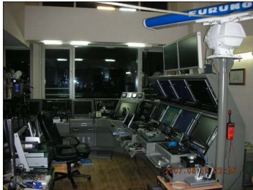
그림.1. CONSOLE 장비 RADAR (X-BAND), 선박 ARPA TARGET NMEA SIGNAL OUTPUT
