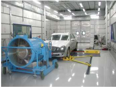
그림 1. 샤시다이내모미터에서의 배기가스 테스트
