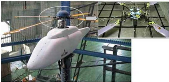
그림 4. 무베어링허브용 십자형 단면 복합재 플렉스빔
