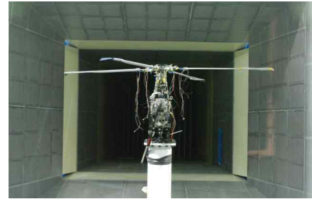
그림 5. 능동 TEF 로터 블레이드 풍동시험
