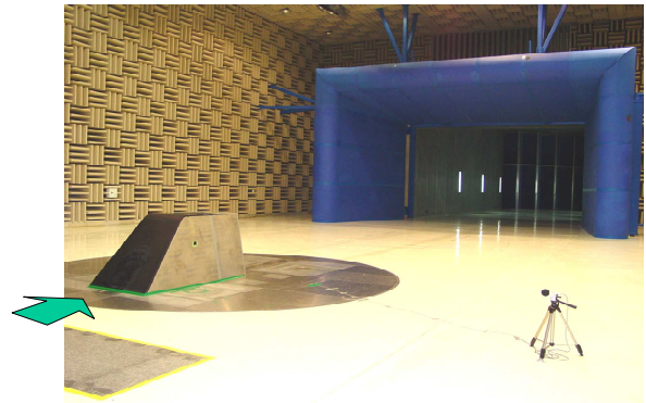
그림 3 실차공력소음풍동 및 소음측정위치
