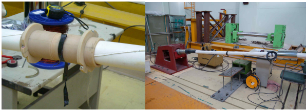
그림 6.코일보빈의 모습 그림 7.EM센서 현장 설치 모습
