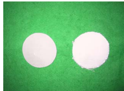
그림 1. 측정대상 유리섬유 직조물 시험체
