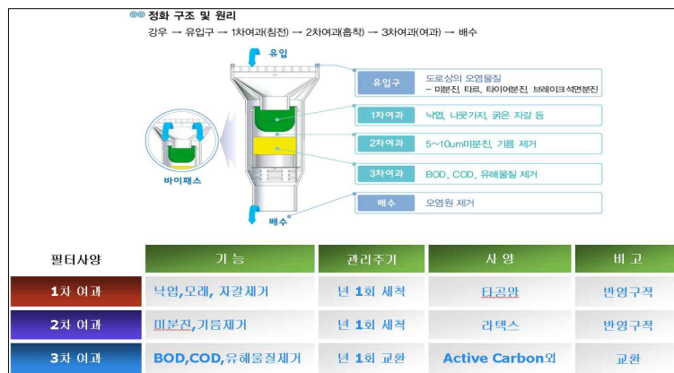
그림.1 소용량 여과식 정화장치 설계도
