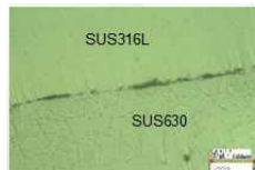
Fig. 4 Microstructure of joining body 둘째, 마이크로 기어의 동종재료 적층확산 실험은
