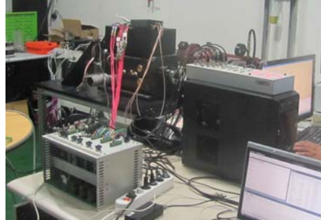
Fig. 3 AMB control system using HILS
