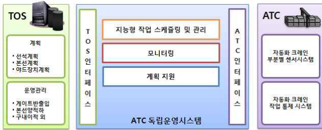
Fig 1. ATC 독립운영시스템 전체 개념도
