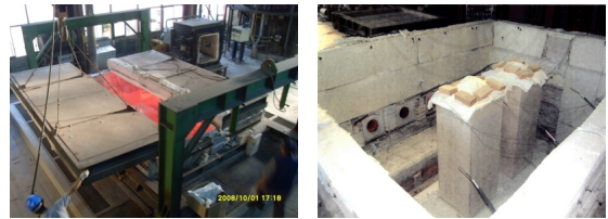
사진1. 내화실험 전경 사진2. 내화실험 후 시험체
