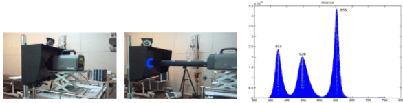
그림 2. 복사휘도 측정장면 및 측정된 스펙트럼
