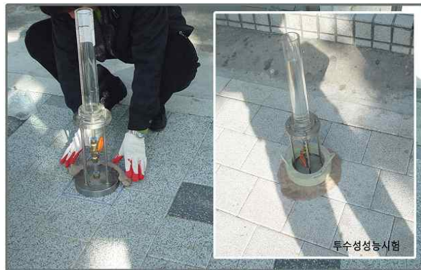
Fig.2 에코스톤바이오 블록의 투수성 성능시험
