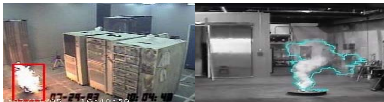
<불꽃감지> <연기감지> 그림 5. CCTV 영상화재감지시스템의 화재감지
