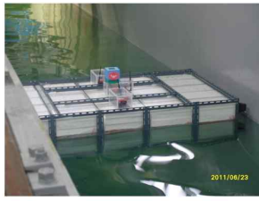
전남대 수조실험실 1차원 파랑실험 및 모형 제작 예시
