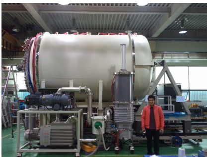
그림1. 대형 플라즈마 표면처리 장치 사진 및 조감도
