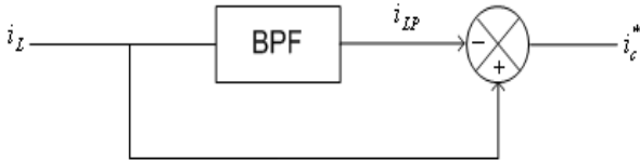
그림2 BPF를 이용한 순시전류제어기 구성도
