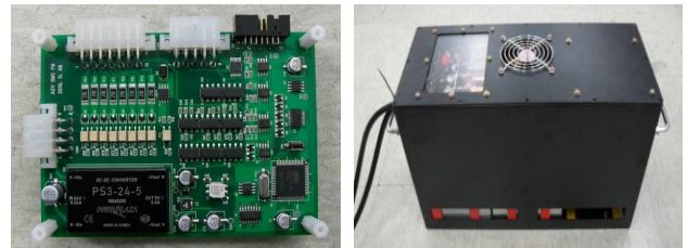
그림 4 AGV용 LiFePO4 배터리 팩 시스템 Fig. 4 LiFePO4 Battery Pack System for AGV
