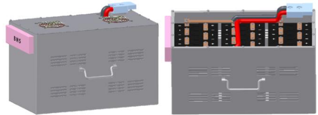
그림 3 배터리 팩의 설계 Fig. 3 Design of Battery Pack
