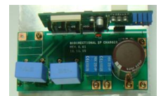
(a) 양방향 Buck 컨버터회로 (b) 실제구현 시스템
