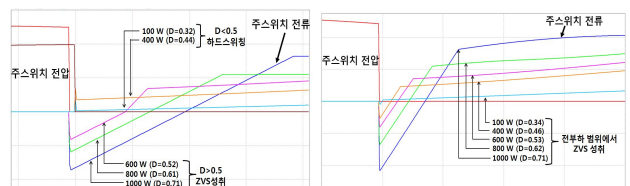
(a) 기존 푸쉬풀/하프브리지방식 (b) 제안하는 방식 그림 2 부하에 따른 주스위치의 스위칭동작
