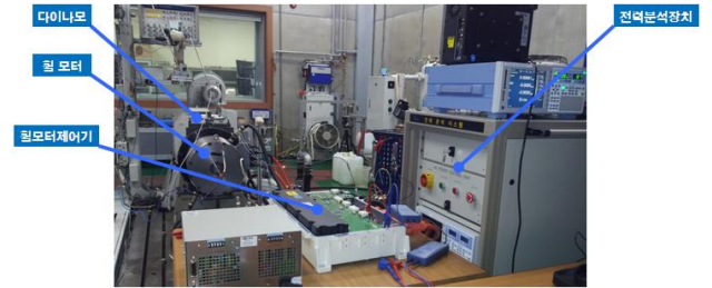
그림 5 다이노모 성능 시험 Fig. 5 Performance test using Dynamometer
