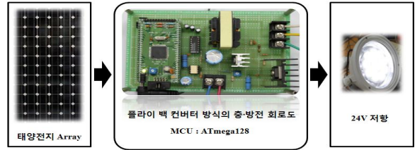
그림 6 배터리 충·방전 제어기 전체 구성도 Fig. 6 Battery controller general block diagram
