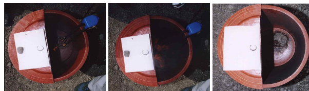
(a) 화염과 연기발생 (b) 착화 연소 확산 (c) 소화 후 바닥 상태
