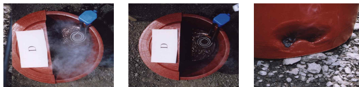
(a) 물이 끓는 상태 (b) 측면에 착화 상태 (c) 용기 외관 상태
