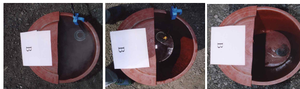
(a) 물이 끓는 장면 (b) 착화된 장면 (c) 소화 후 바닥 상태
