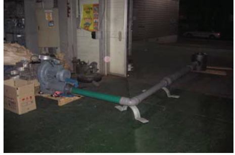
Figure 15. 압력손실 TEST 시스템
