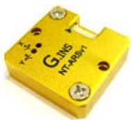
Fig. 1 본 실험에서 사용된 자세 측정용 ARS 센서
