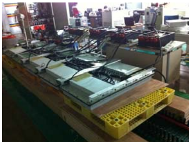
Fig. 3 철도용 비접촉 집전 시스템 시험
