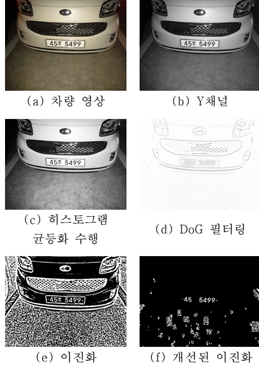
그림 2. 차량 영상의 이진화 과정 단계에서 생성되는 영상들의 예
