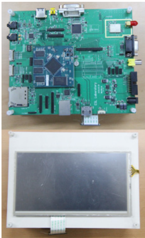
그림5. Cortex-A8기반의 Navigation Prototype Hardware Platform
