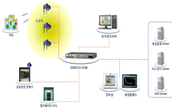
그림 1 위치확인용 원패스 시스템 구성도
