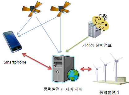
그림4. 스마트폰 모니터링 풍력발전기 개념도
