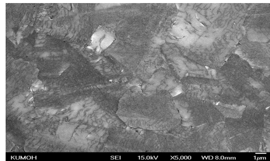
그림 2. 전계방출 주사전자현미경을 이용하여 측정한 마이크로다이아몬드 형태 이미지
